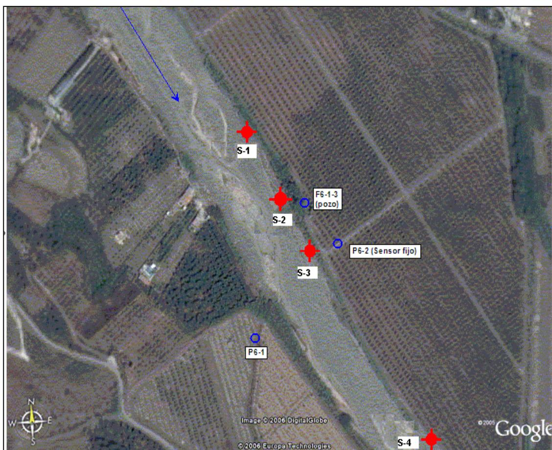
**Figura 2.2.** Detalle de la foto de la figura 2.1 que incluye la situación de las perforaciones (S1 a S4) y otros puntos cercanos. La flecha señala la dirección del río.
